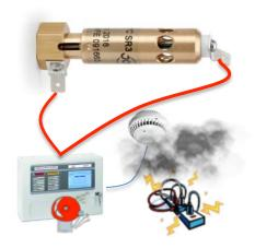
R-AMFE funciona como um AMFE convencional, liberando o NOVEC™ após a temperatura de disparo ter sido atingida. Além disso, o R-AMFE pode ser acionado remotamente por meio de um sinal para o R-AMFE causando um aumento rápido e preciso do calor no bulbo, resultando em acionamento do R-AMFE e liberação do NOVEC™.
